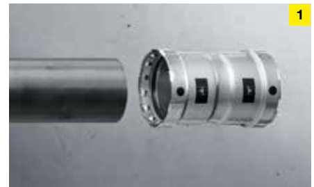
Tērauda caurule tiek nozāģēta un notīrta. Pēc tam tiek nomērīts un atzīmēts ievietošanas dziļums. Pēc tam uz caurules līdz atzīmei tiek uzbūvēts Megapress veidgabals.
