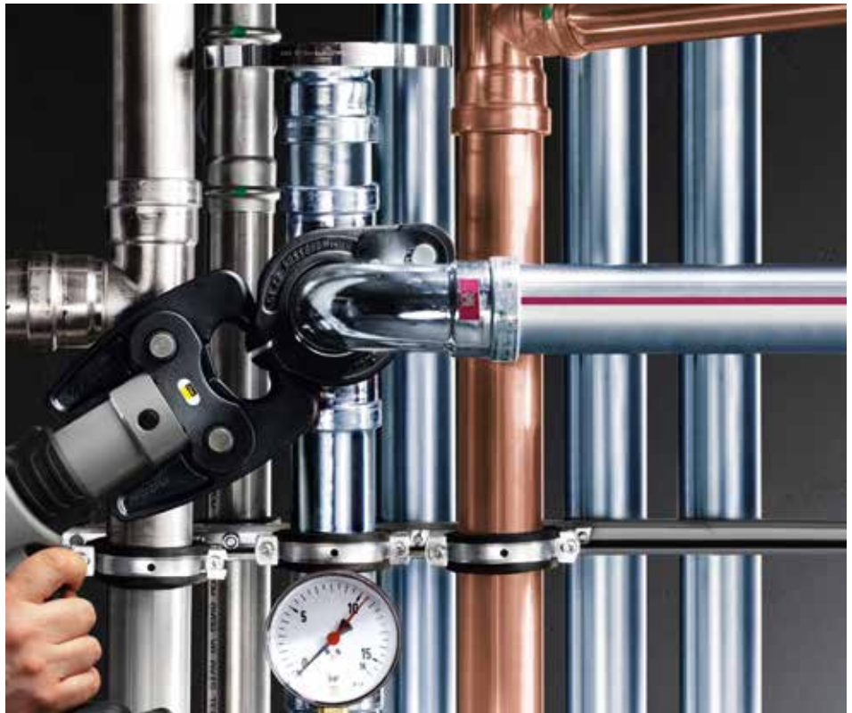
Izmantojot presēšanas gredzenu, var viegli izveidot liela šķērsriezuma cauruļu presētos savienojumus.
