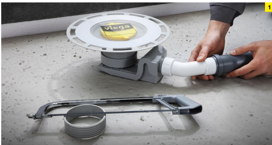
Garnitura odvoda laka za čišćenje, model 4927 s fleksibilnim priključnim lukom, za po izboru 40 ili 50 mm dugu priključnu cev.
