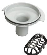
vertikalni model, bez sifona, sa filterom za prljavštinu, Odlivni kapacitet kod visine uspora 10 mm 1,2l/s, Odlivni kapacitet kod visine uspora 20 mm 1,2l/s, Model 4982.83
