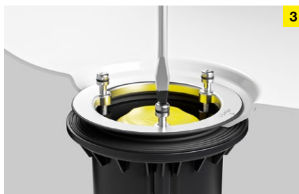
3 Poravnati odvod, postaviti pričvrsnu priрубnicu na zaptivač i zavrnuti sa odvodnim kućištem.
