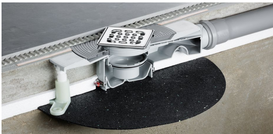
Advantix Top odvod osiguran od vraćanja barijerom za vodeni stub sa srednjim otvorom za protok i bočnim džepovima.
