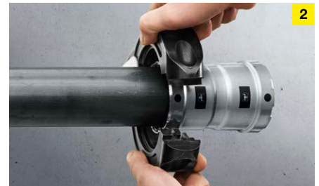
1\frac{1}{4} tollist suuremate Megapressi liitmike pressimiseks kasutatakse ainult liigendadapterlõugadega pressrõngaid. Väiksemate suuruste ( \frac{3}{8} kuni 1 toll) jaoks on olemas nii presslõuad kui ka liigendadapterlõugadega pressrõngad.
