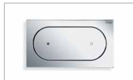
Visign for Style 23: Decentne zapadne do každej steny a každého kusa nábytku. Ovláda sa pomocou vyznačených bodov pre veľké a malé splachovacie množstvo.
